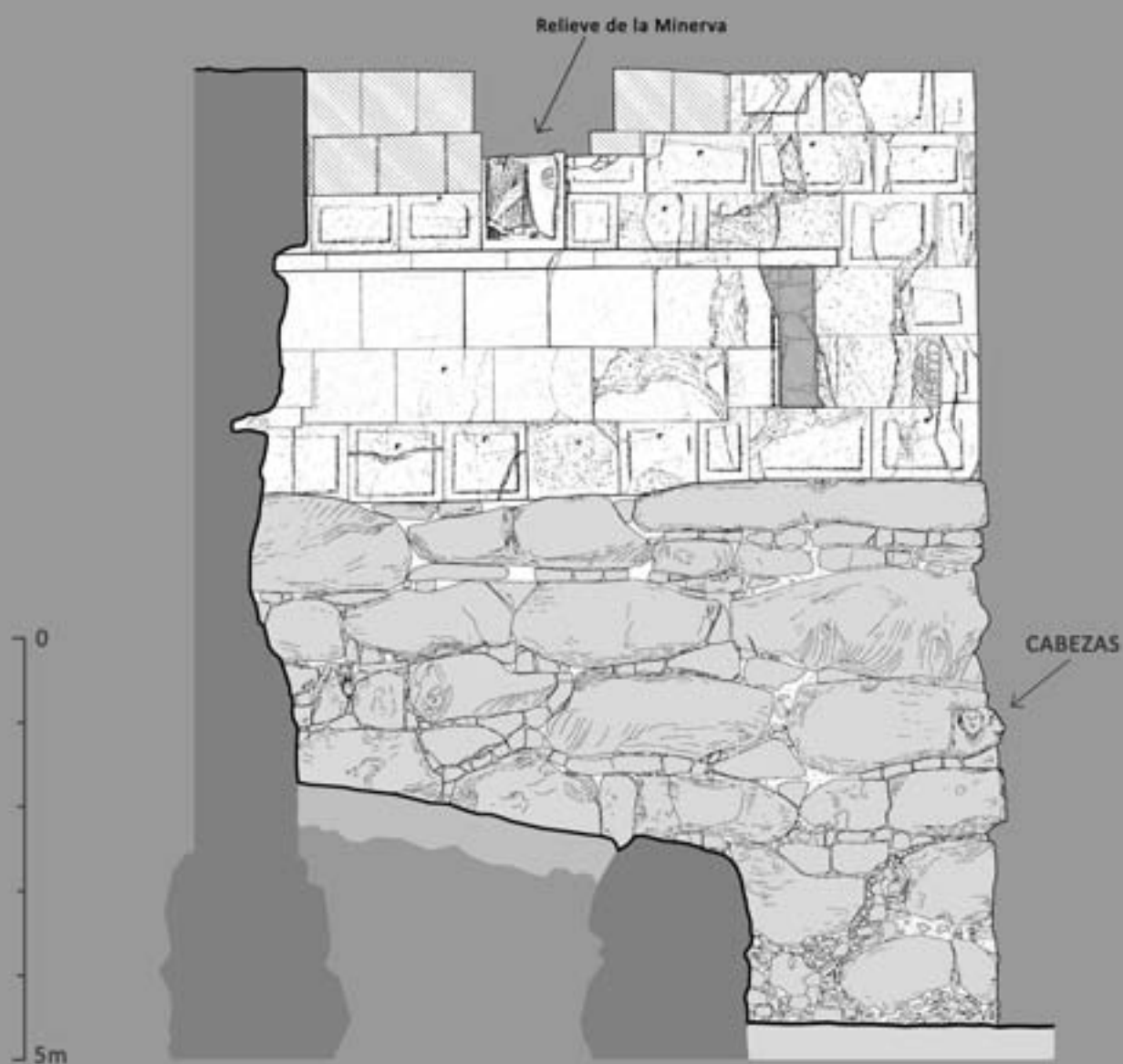
Fig. 18: Alzado lateral de la Torre de Minerva en la actualidad (Hauschild 1975). El derrumbe del lienzo de sillares de la Fase II de la Muralla (M II) dejó a la vista la fachada de la torre con el célebre relieve demostrando que la torre pertenecía a una primera fase del sistema defensivo.
